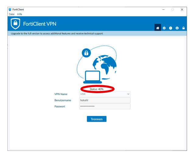
Sollte die FortiClient VPN-Verbindung bei 40% stehen bleiben, muss die Meldung im zweiten Fenster bestätigt werden.
